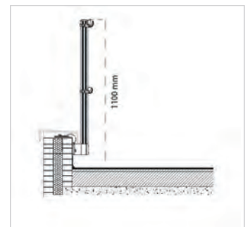
Z-Typ Wandhalterung für Montage unter Attikaabdeckung
