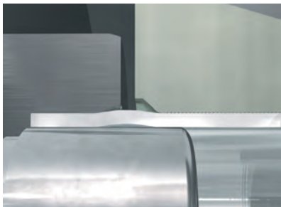
Während des Stauchvorgangs wird das Rohr umgeformt und das Material verfestigt
